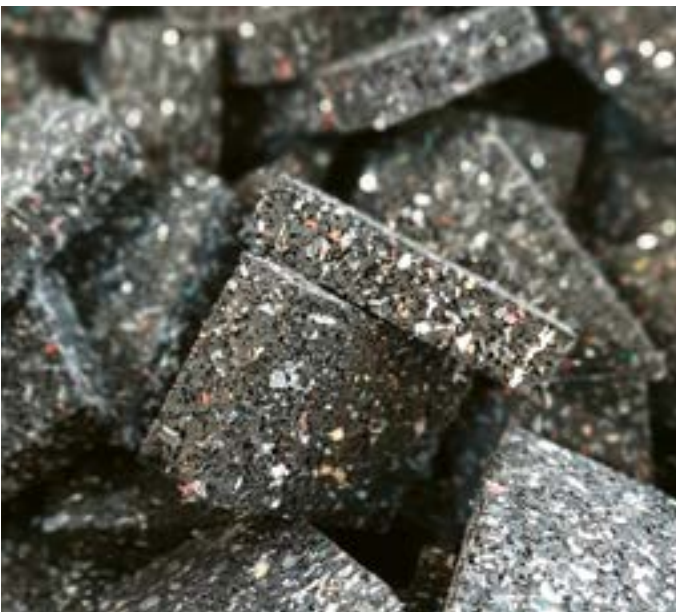
Isopads aus 95 % Altreifengranulat
