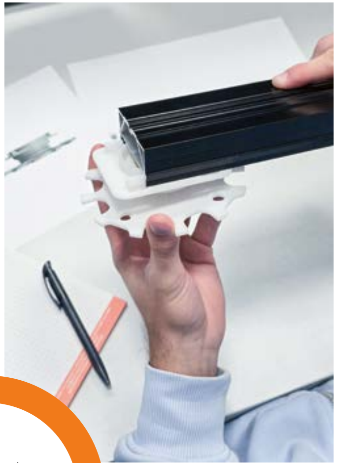
Test mit 3D-Modell an vorhandenen Produkten
